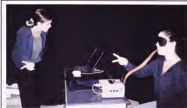
Subyek yang ditutup matanya mengikuti gerakan tangan yang sedang direkam oleh kamera video (kotak putih di samping komputer laptop ) dan ditransmisikan ke alat penerjemah gambar di lidah).
