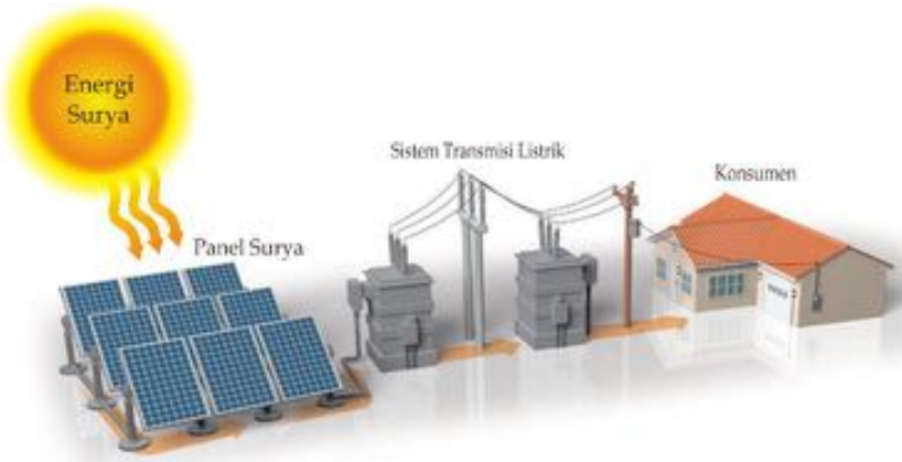
Gambar 9 Cara Kerja Pembangkit Listrik Tenaga Surya 174
