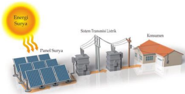
Gambar 6 Cara Kerja Pembangkit Listrik Tenaga Surya 133
