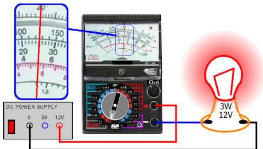
Gambar 3.14. Pembacaan hasil pengukuran arus DC pada Multimeter.
