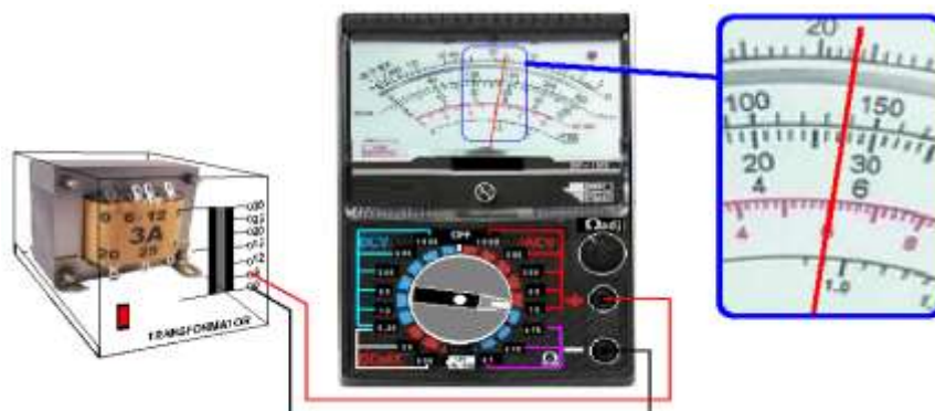
Gambar 3.13. Pembacaan hasil pengukuran tegangan AC pada Multimeter.
