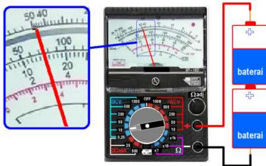
Gambar 3.12. Pembacaan hasil pengukuran tegangan DC pada Multimeter.
