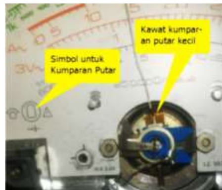
Gambar 3.4. Aplikasi kumparan putar pada multimeter.
