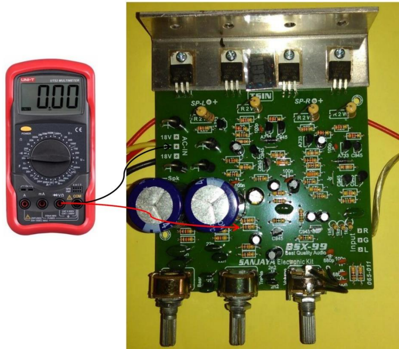
Gambar 3.8. Pengukuran tegangan DC pada rangkaian pengatur nada
