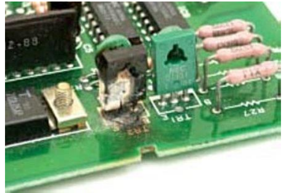
Gambar 3.2. Contoh transistor rusak, terlihat secara visual
