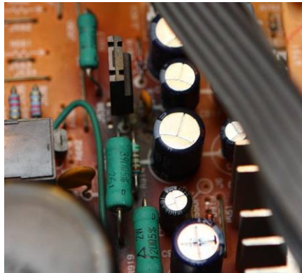
Gambar 3.2. Contoh transistor rusak, terlihat secara visual
