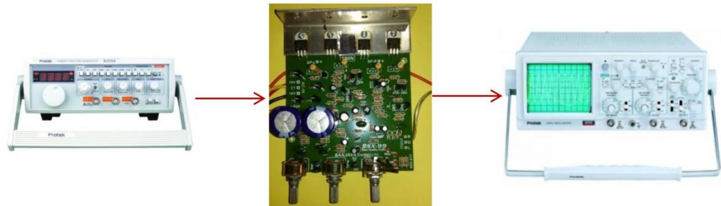
Gambar 3.10. Pengukuran tegangan sinyal menggunakan oscilloscope
