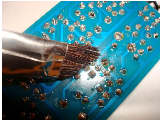
Gambar 4.1. Pembersihan menggunakan kuas
