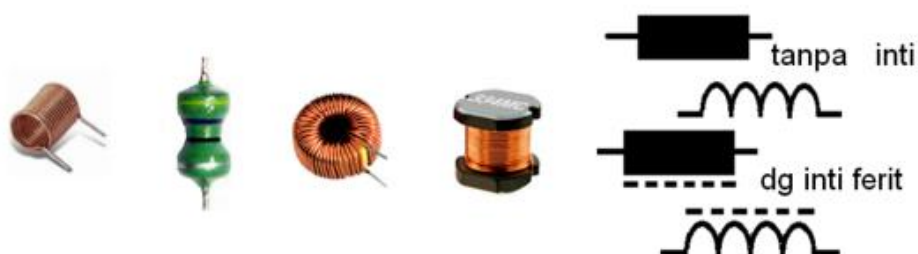
Gambar 5.11. Induktor sebagai rangkaian filter
