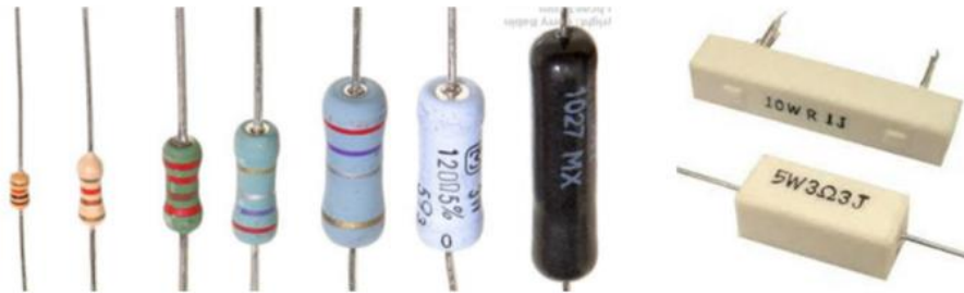
Gambar 3.1. Resistor dengan kemampuan disipasi daya yang berbeda.
