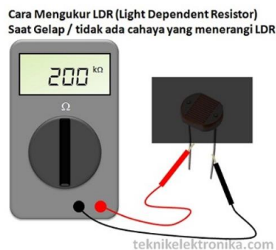
Gambar 6. 9. Mengukur LDR pada Kondisi gelap
