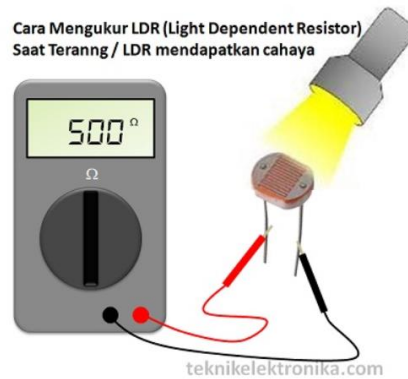
Gambar 6. 8. Mengukur LDR pada Kondisi Terang
