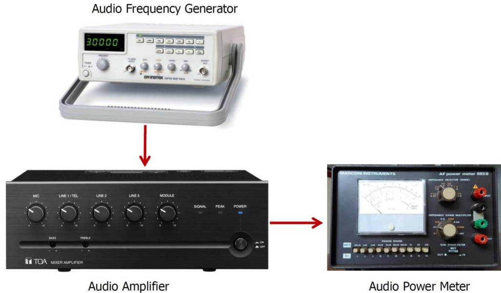
Gambar 3.3. Ilustrasi pengukuran dengan audio power meter.
