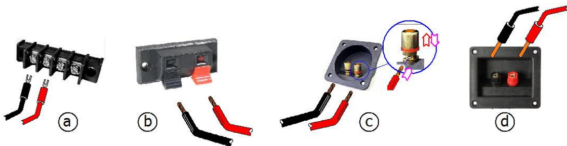
Gambar 2.48. Macam-macam terminal speaker dan cara menghubungkan kabel speaker.
