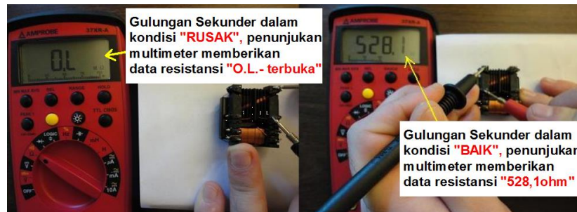
Gambar 7-L. Uji Kontak dengan Multimeter standar
