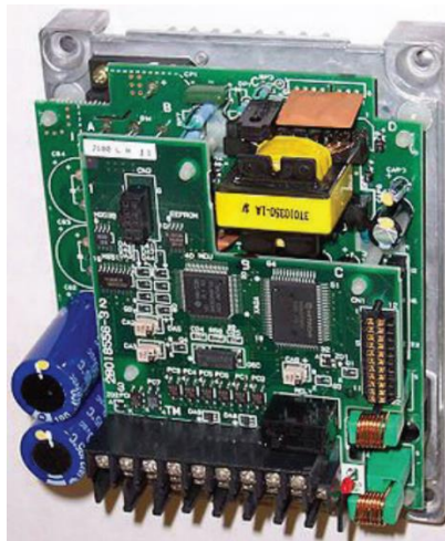
Gambar 4. 7. Sebuah representasi gambar piktorial dari VFD-Variable Frequency
