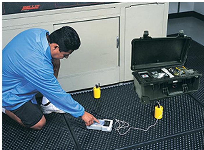
Gambar 2. 50. Pengukuran ESD Lantai Anti Statik
