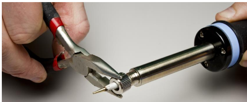
Gambar 2. 12. Memasang ujung besi solder dengan benar dan tidak terlalu kencang
