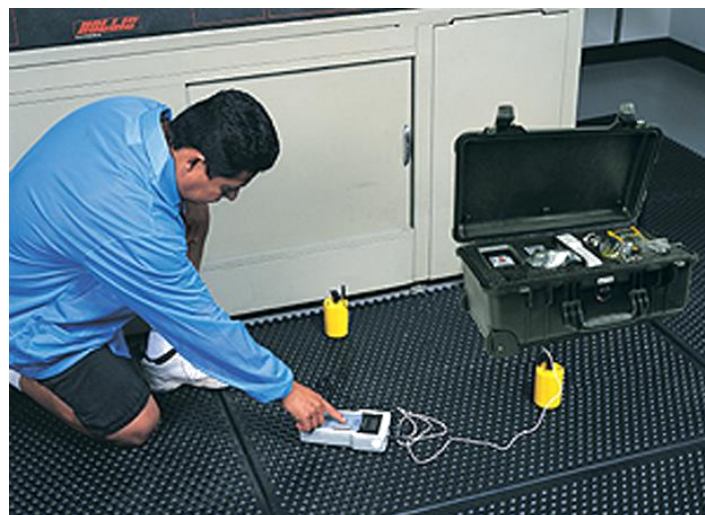
Gambar 2. 50. Pengukuran ESD Lantai Anti Statik
