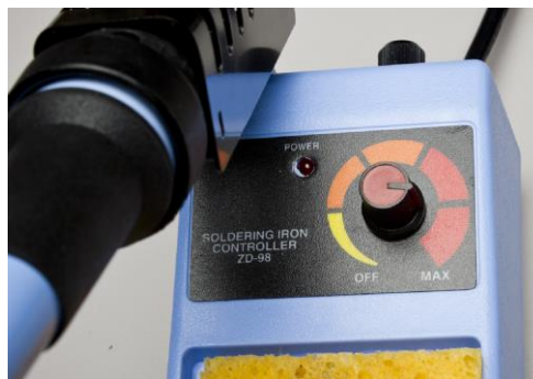
Gambar 2. 14. Mengatur Tempetarur pada jam 15.00
