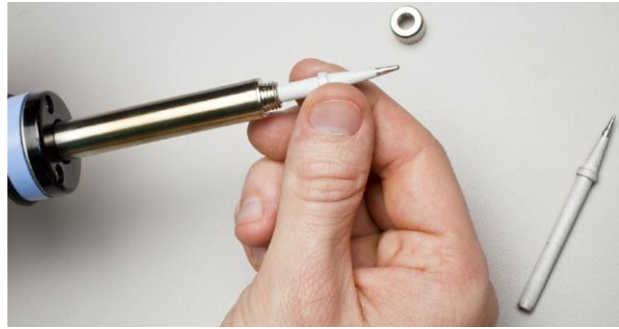
Gambar 2. 11.Memasukkan ujung ke dalam tabung
